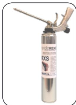
Sistema di fissaggio a base di schiuma poliuretantica, monocomponente, tixotropica, ad **alta adesività e bassa espansione**, classe di resistenza al fuoco B2, con conducibilità termica pari a  $\lambda_D = 0,035 \text{ W/mK}$ .
