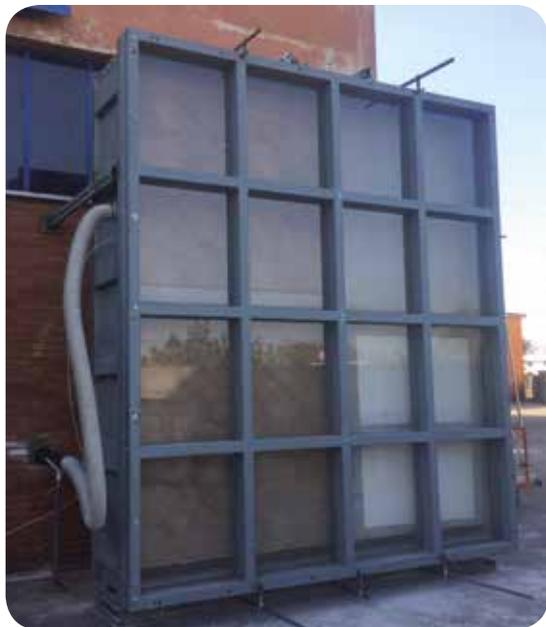
Configurazione parete: sistema spideREX K8 con lastre RXL dark (spessore 8 e 20 cm) con e senza rivestimento ceramico/lapideo.
